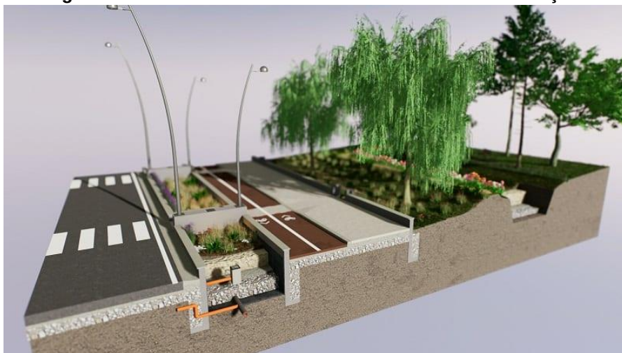
Figura 43: Detalhamento de Sistema de Jardim de Infiltração.
