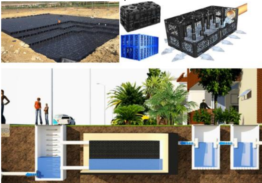
Figura 54: Desenhos esquemáticos e foto real de sistema de infiltração de produto importado.
